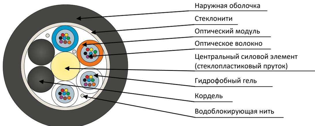
Кабель содержит сердечник модульной конструкции с центральным силовым элементом из диэлектрического стержня со спирально наложенной водоблокирующей нитью, вокруг которого скручены оптические модули со свободно уложенными волокнами. Сердечник скреплен обмоточными нитями с водоблокирующим свойством. На сердечник спирально накладываются стеклонити и оболочка из полиэтилена средней плотности.
