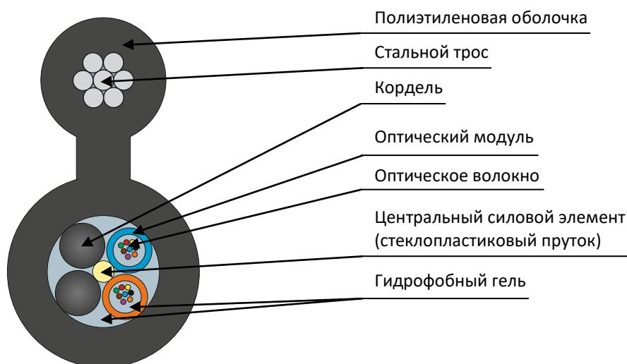
Кабель содержит сердечник модульной конструкции с центральным силовым элементом из диэлектрического стержня, вокруг которого скручены оптические модули со свободно уложенными волокнами. Свободное пространство в оптических модулях и в сердечнике кабеля заполнено гидрофобным гелем. В качестве подвесного элемента используется стальной трос. На сердечник и подвесной элемент накладывается оболочка из полиэтилена средней плотности.
